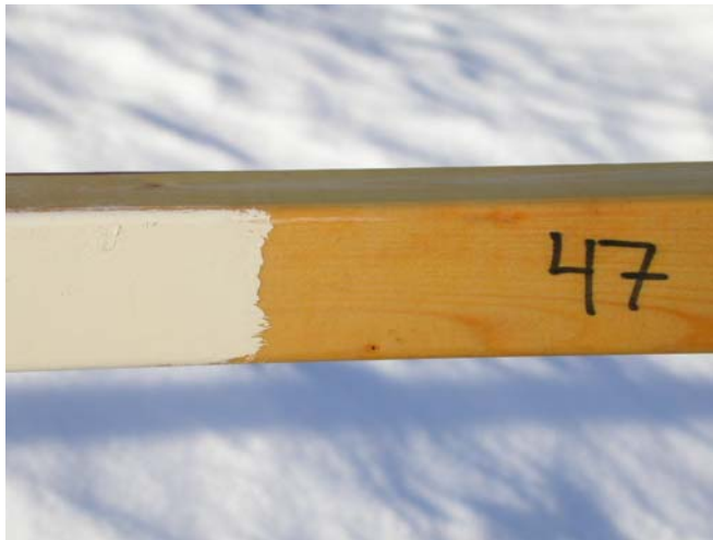
En 45*70 regel av gran impregnerad i Linotech-processen och därefter färglagd.
