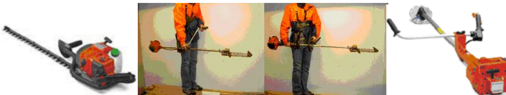
Motormanuella röjningsredskap: 1) Häcksax, 2) Stångsåg 1, 3) Stångsåg och 4) Konventionell röjsåg. Alla av fabriken Husqvarna. Foto doktorand Karin Fällman, SLU.
