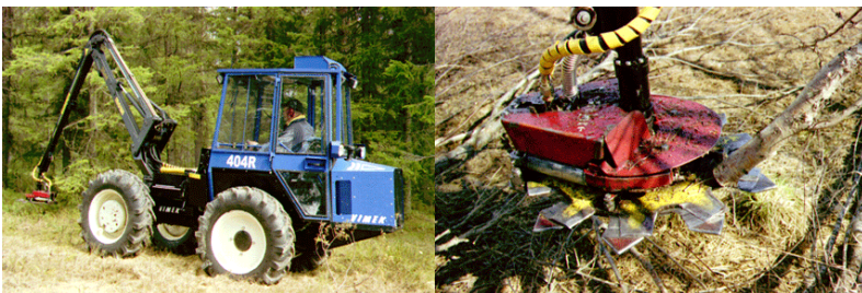
Mekaniserad röjningsmaskin av fabriken VIMEK. 1) Basmaskin med kran och röjaggregat. 2) Detaljbild av det fram- och återgående klippande röjaggregatet. Foto Vimek.
